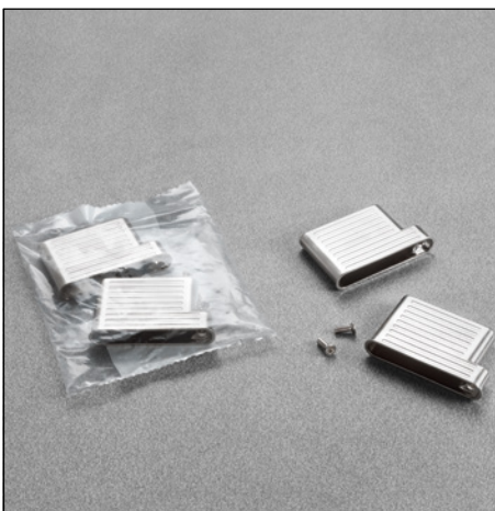
Inserts pour bras de charnière, à insérer et fixer dans le panneau haut et bas du meuble pour redonner la compacité au matériau. Ils couvrent également les éventuelles imperfections résultant de l'usinage du meuble.
